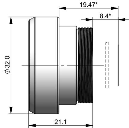
\*数据适配于 1.0 毫米的锗探测器窗口
