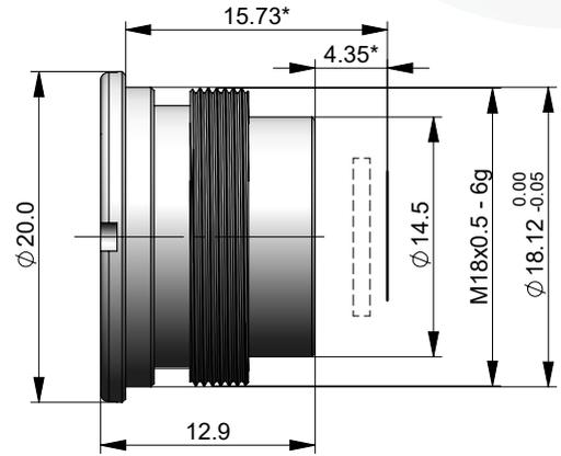
\*数据适配于 0.63 毫米的硅探测器窗口
